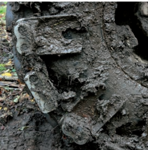
▲ Abb. 4: Etwa 15 cm lange Seitenplatten verhindern, dass die Street-Rubbers beim Fahren von den Rädern rutschen. Die Spannung der Bänder kann mit längeren Verbindungsgliedern (2. v. o.) angepasst werden
