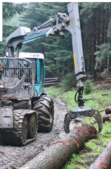
▼ Mit Klemmbank beim Langholzrücken
