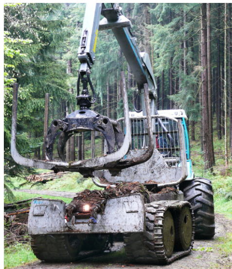
▲ Der Rungenkorb kann in kurzer Zeit abmontiert werden
