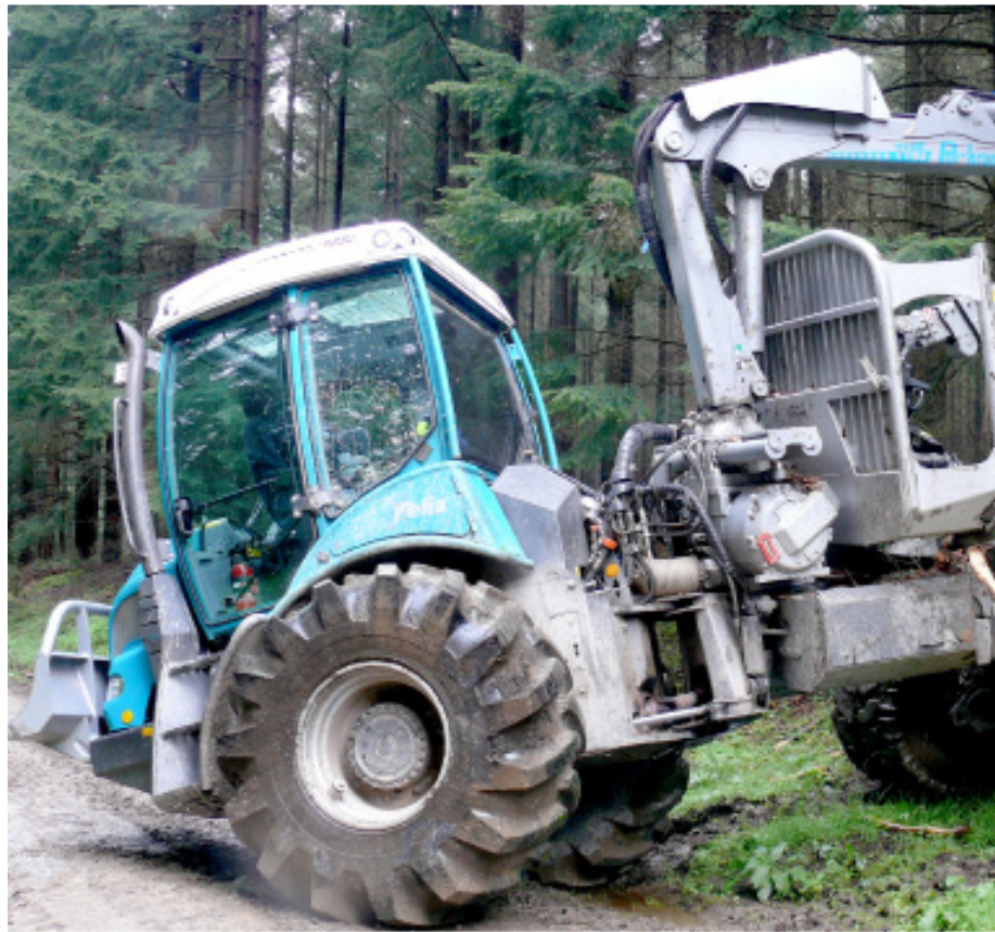
▲ Der Felix ist mit seiner kurzen Schnauze unverwechselbar, hier ist er mit dem Street-Rubbers-Laufwerk „ForstTracker Quattro“ im Einsatz
