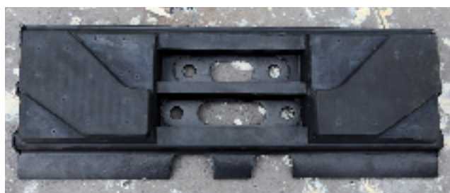
Abb. 3: Das erste Muster einer Bond-Platte. Sie werden direkt mit dem Fahrwerk verschraubt und ersetzen die Bodenplatten aus Stahl, in die Aussparung können Traktionselemente eingesetzt werden
