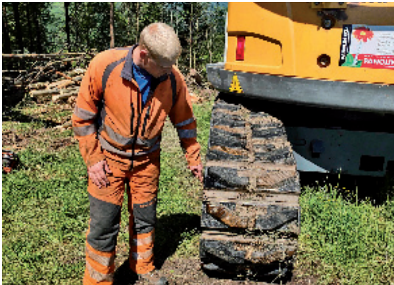
Abb. 2: Remo Schatt verwendet abwechselnd Slip-on-Elemente mit Gummi- und Gussstahlprofil
